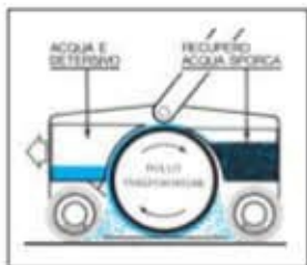
SCHEMA DI FUNZIONAMENTO: 2 SPAZZOLE A ROTAZIONE CONTRAPPONTE CONVOGLIANO LO SPORCO SUL RULLO TRASPORTATORE PER IL RECUPERO
