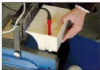
SERBATOIO ANTERIORE PER CONTENERE L'ACQUA CON IL DETERGENTE
